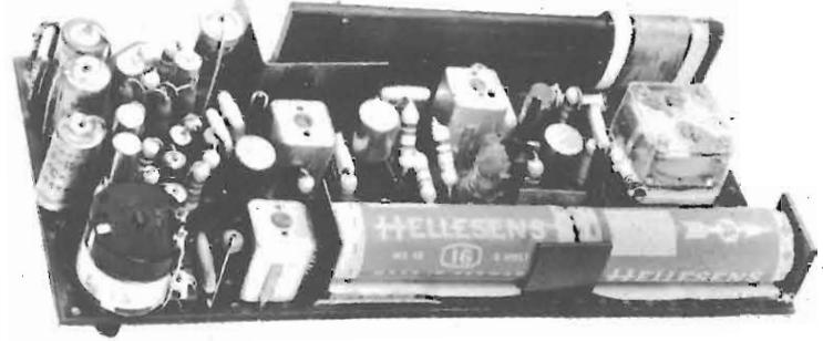
Fig. 2 - Realizzazione sperimentale del circuito a sette transistor.
