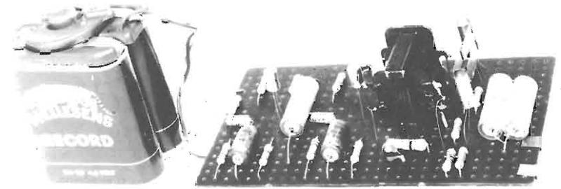
Fig. 2 - Realizzazione sperimentale dell'amplificatore «single ended» da 1 W.
